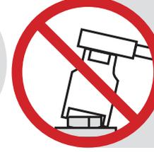
**Lokma anahtarlarınızı uygun ölçülerdeki cıvata, en geniş yüzeyde dik olarak kullanınız. Lokma anahtarların cıvataya eğik olarak takılıp kullanılması, kavrama yüzeyini azaltarak ürünün kullanım ömrünü kısaltacaktır.**
