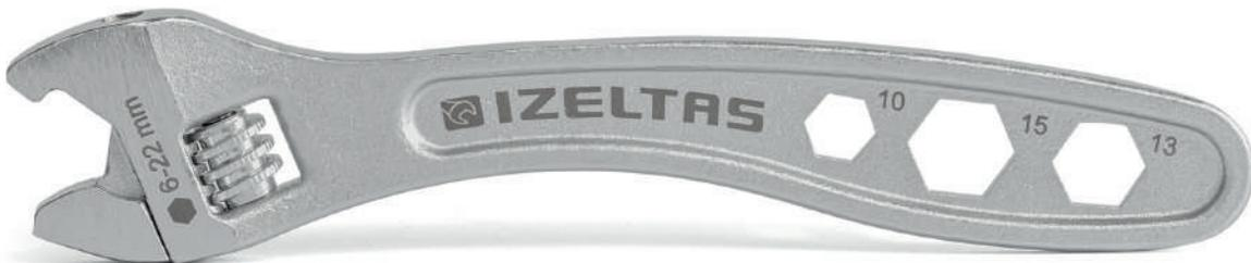
6 ile 22 mm arası altı köşe, torx,yive ,ribe, kare gibi farklı geometriye sahip civataları açabilme imkanı sağlar. Anahtarı civata başından tam olarak çıkarmadan açma ve sıkma hareketi olanağı sağlar. Anahtar sapına özel olarak açılmış 10-13-15 mm altı köşe civataları açabilme imkanı sağlar.
