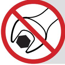
**Anahtarlarınızı, ağız ölçüsüne uygun cıvatalarda kullanınız. Anahtar ve cıvata arasındaki ölçü uyumsuzluğu, üründe ağız aşınmasına neden olur.**
