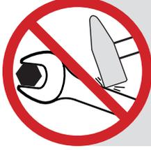
**Anahtar gövdesine çekiç ile darbe uygulamayınız. Ağız yapısında bozulmalara, kırılma ve yaralanmalara neden olabilir.**
