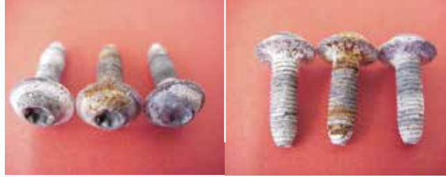
Ohne EJOSEAL-Beschichtung Korrosion nach 456 h Testdauer nach DIN 50021 (Schichtdicke Zink 8µ blau)
